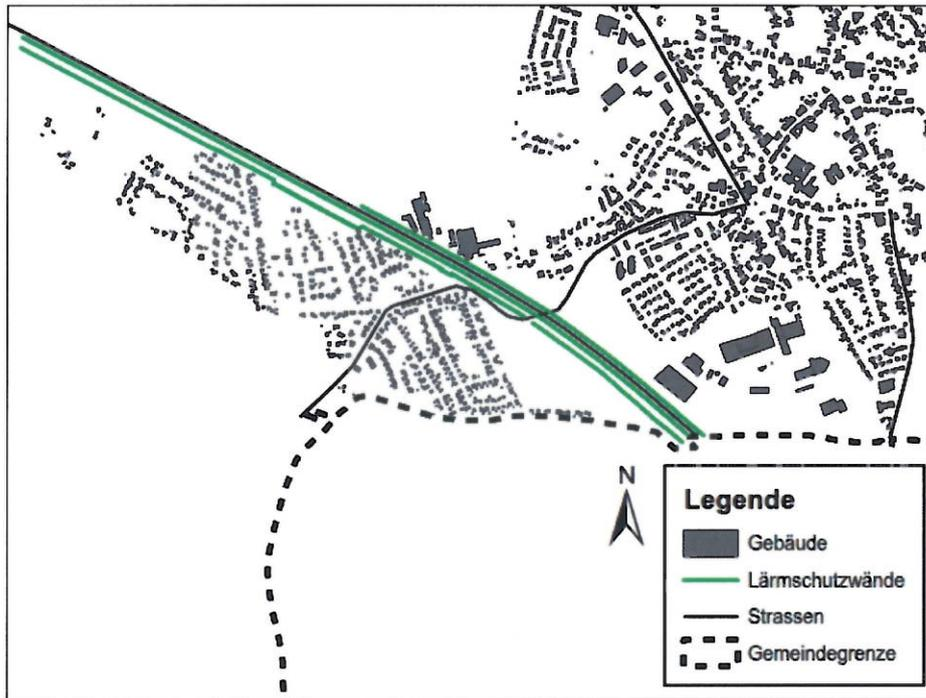
Das EBA hat bei seiner Lärmkartierung diese Lärmschutzwände an der Haupt-eisenbahnstrecke und der BAB A39 nicht berücksichtigt. Daraus resultiert ein falsches Bild der Lärmbelastung durch die Haupteisenbahnstrecke (s. Anlage 2 und 3). Zusätzlich wurden die Belastetenzahlen nicht mit den tatsächlichen Einwohnerzahlen je Wohngebäude berechnet (s. Kap. 2.2), so dass im Ergebnis der Lärmkartierung des EBA zu viele belastete Anwohner in Bardowick dargestellt werden.
