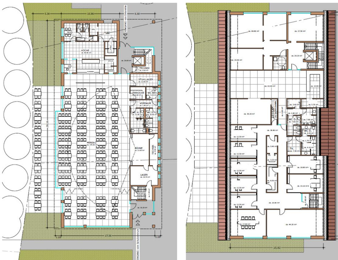
Abbildung 16: Grundrisse Integrationszentrum – Vorplanung, Erdgeschoss (links) und Dachgeschoss (rechts)
