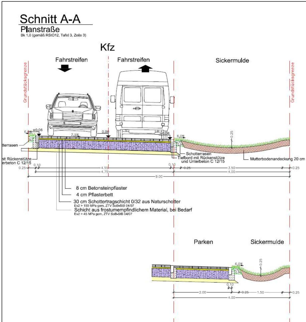
**Abb. 6:** Auszug Regelquerschnitt Erschließungsstraße, Anlage 4.1 Entwässerungskonzept. Erschließung NGB Heidacker 2 in Wittorf, Ingenieurbüro Beußel, 13.08.2021
